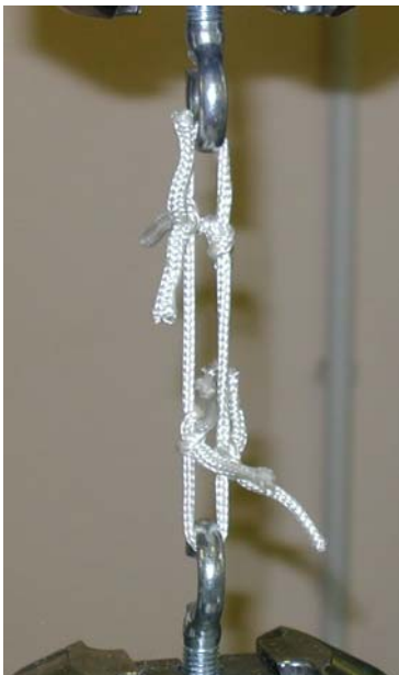
Figura 2. Disposizione dei campione di maglia nella macchina di prova: (a) maglie quadrate di lato \ell_M=60\text{mm} ; (b) maglie quadrate di lato \ell_M=100\text{mm} .
