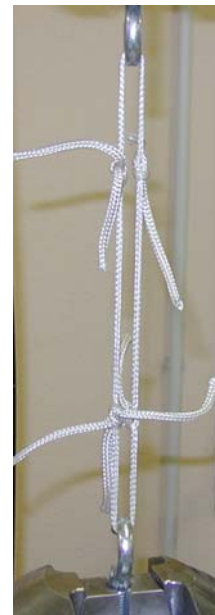
Figura 2. Disposizione dei campione di maglia nella macchina di prova: (a) maglie quadrate di lato \ell_M=60\text{mm} ; (b) maglie quadrate di lato \ell_M=100\text{mm} .
