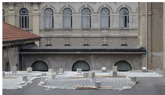
Figura 1. Invecchiamento naturale di alcuni campioni di rete.
